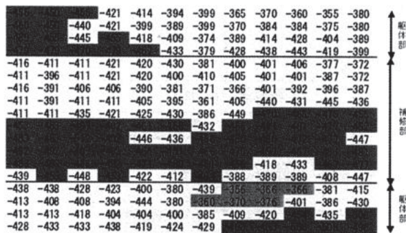
図10 亜硝酸リチウムを用いる工法で補修した供試体の補正自然電位
